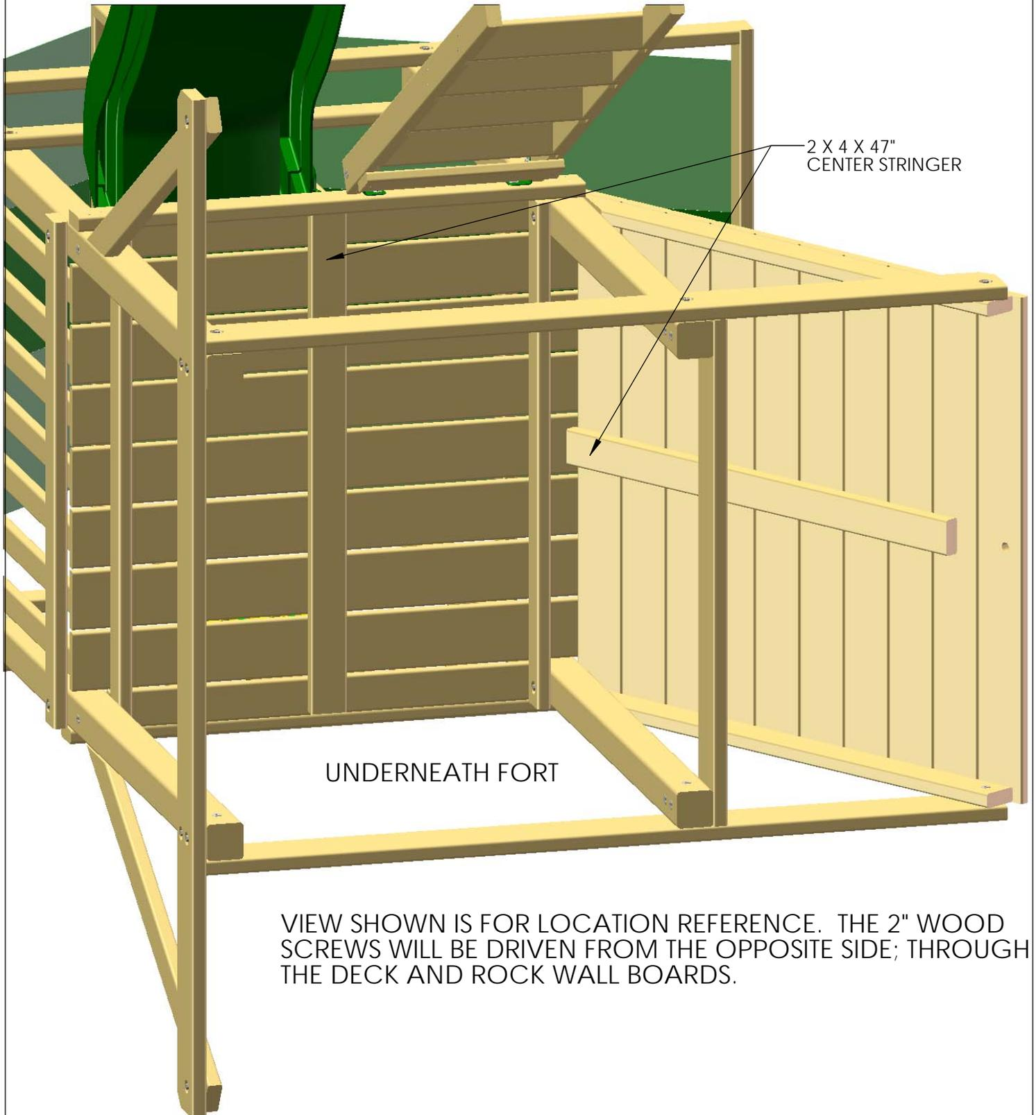
VIEW SHOWN IS FOR LOCATION REFERENCE. THE 2" WOOD SCREWS WILL BE DRIVEN FROM THE OPPOSITE SIDE; THROUGH THE DECK AND ROCK WALL BOARDS.
