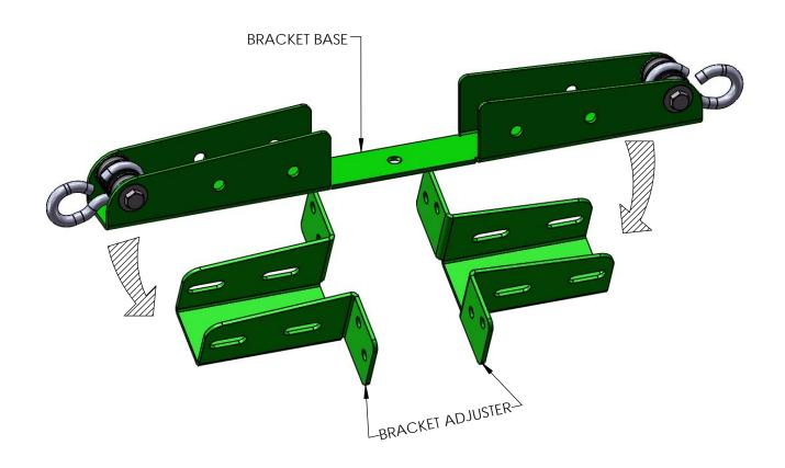
3: LINE UP THE SLOTS IN THE BRACKET ADJUSTERS WITH THE HOLES IN THE BRACKET BASE. SPACE THE BRACKET ADJUSTERS EVENLY APART.
