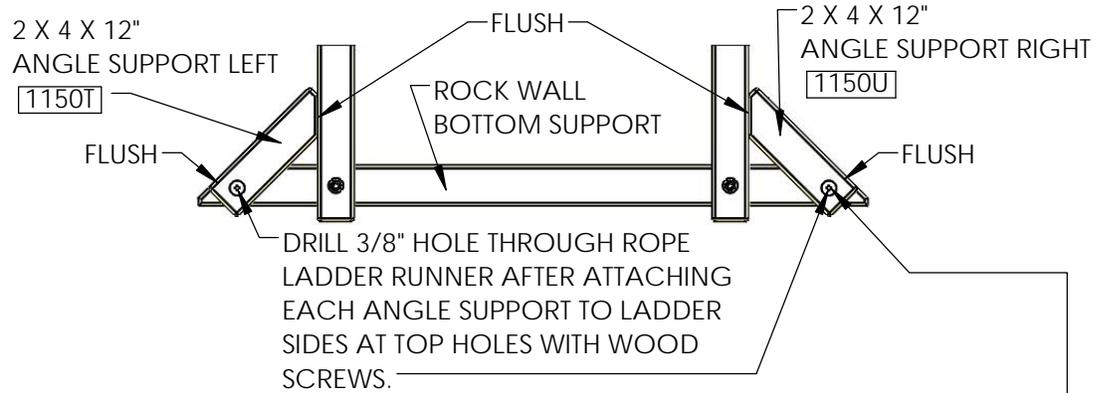
TIP: PUT A SCRAP BLOCK OF WOOD BEHIND THE ROCK WALL BOTTOM SUPPORT WHEN DRILLING THE HOLES TO MINIMIZE CHIP-OUT ON THE BACK SIDE.
