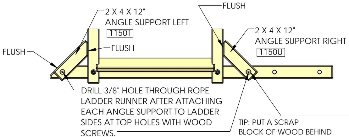
TIP: PUT A SCRAP BLOCK OF WOOD BEHIND THE ROPE LADDER RUNNER WHEN DRILLING THE HOLES TO MINIMIZE CHIP-OUT ON THE BACK SIDE.
