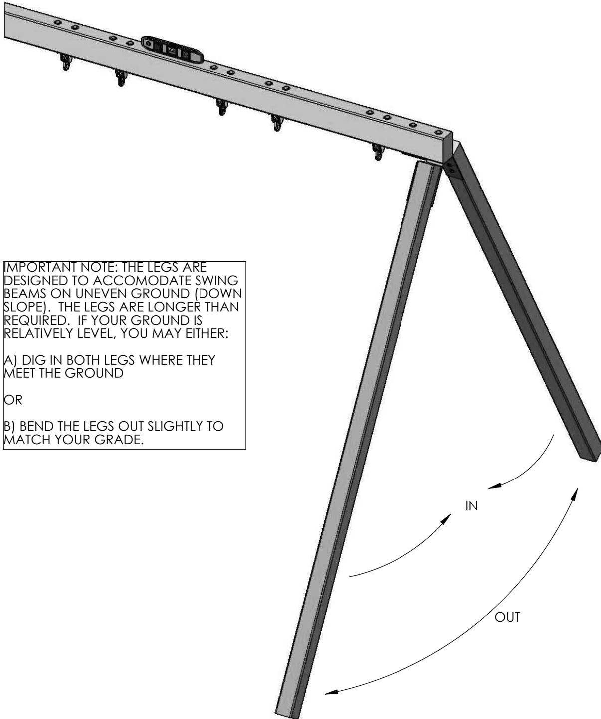
IMPORTANT NOTE: THE LEGS ARE DESIGNED TO ACCOMODATE SWING BEAMS ON UNEVEN GROUND (DOWN SLOPE). THE LEGS ARE LONGER THAN REQUIRED. IF YOUR GROUND IS RELATIVELY LEVEL, YOU MAY EITHER:
